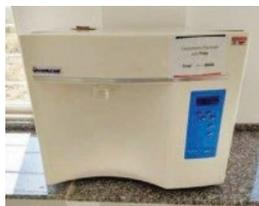
Sistema de purificação de água ICP/MS, cromatografia iônica, HPLC, cromatografia gasosa, TOC, espec. – Laboratório de Materiais
