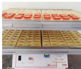
Mesa Agitadora Orbital para Solos - Laboratório de Análises Agrícolas
