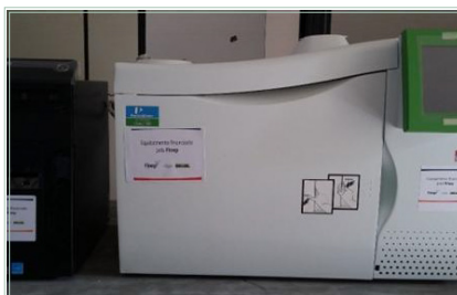
Sistema de cromatografia gasosa acoplada a Espectrometria de massas. Data: 25/08/2015 – Laboratório CPMUA/ CUA/UFMT
