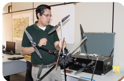
Aeronave remotamente pilotada do tipo asa rotativa, hexacóptero, modelo X800, homologada pela Agência Nacional de Telecomunicações (Anatel) e registrada na Agência Nacional de Aviação Civil (Anac) ajuda a contextualizar a área do parque.
